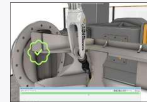
パスの衝突・ジョイント制限突破・到達可否の確認・特異点などのさまざまなエラーもワンクリックで一括修正
